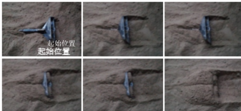
图 1 模型锚啮土进程
